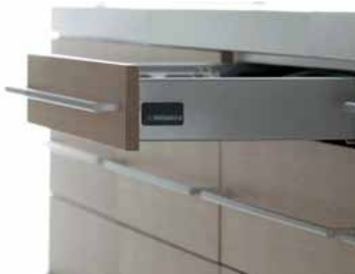
Cajon de costilla metálica color gris con quías de extracción total de 50 kilos de carga. Steel sided drawer color grey with ball bearings runners and shock absorber. Full extension runners 50 kg.
